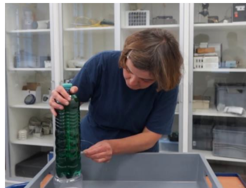
Abbildung 1: In die mit Wasser befüllte Flasche werden kleine Löcher gestochen
