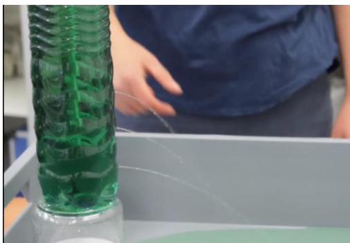
Abbildung 2: Je nach Höhe des Loches strahlt das Wasser unterschiedlich weit heraus
